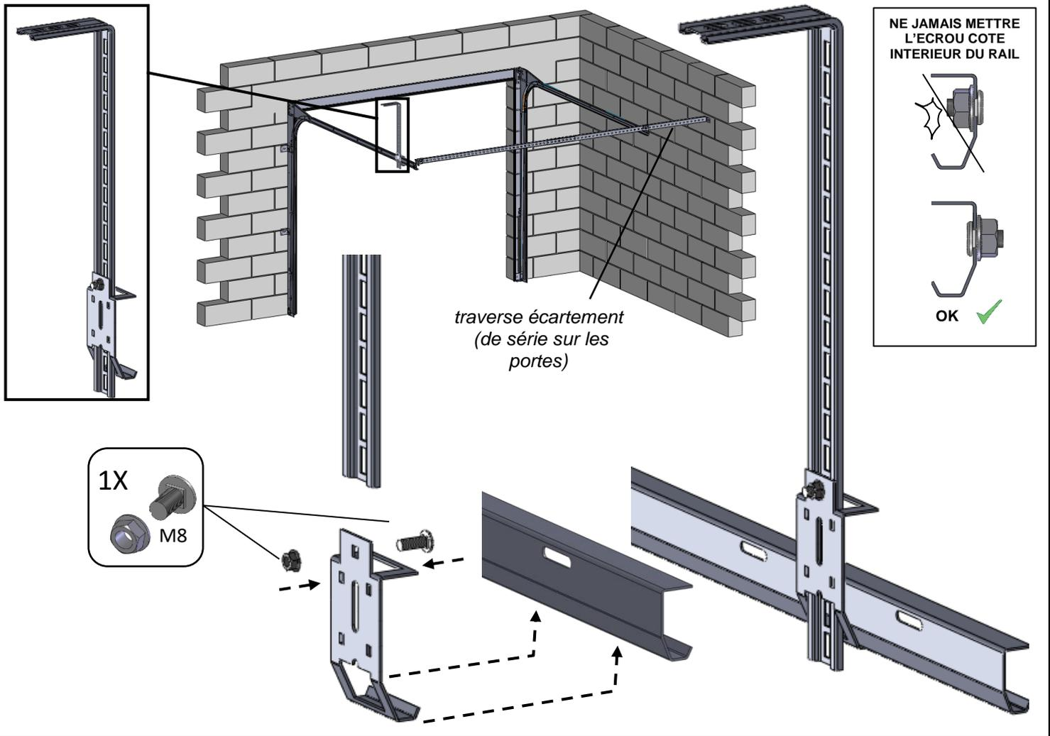
QUELQUES EXEMPLES DE CONFIGURATIONS : Suspentes pour fixation sur les cotés
