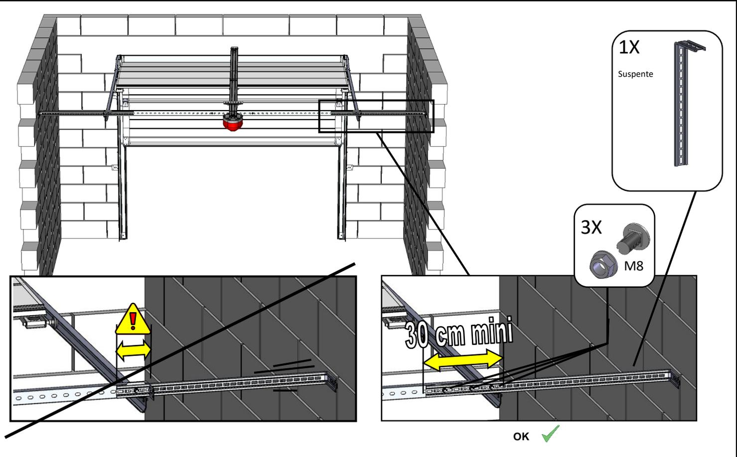
QUELQUES EXEMPLES DE CONFIGURATIONS : Suspentes pour moteur au plafond
