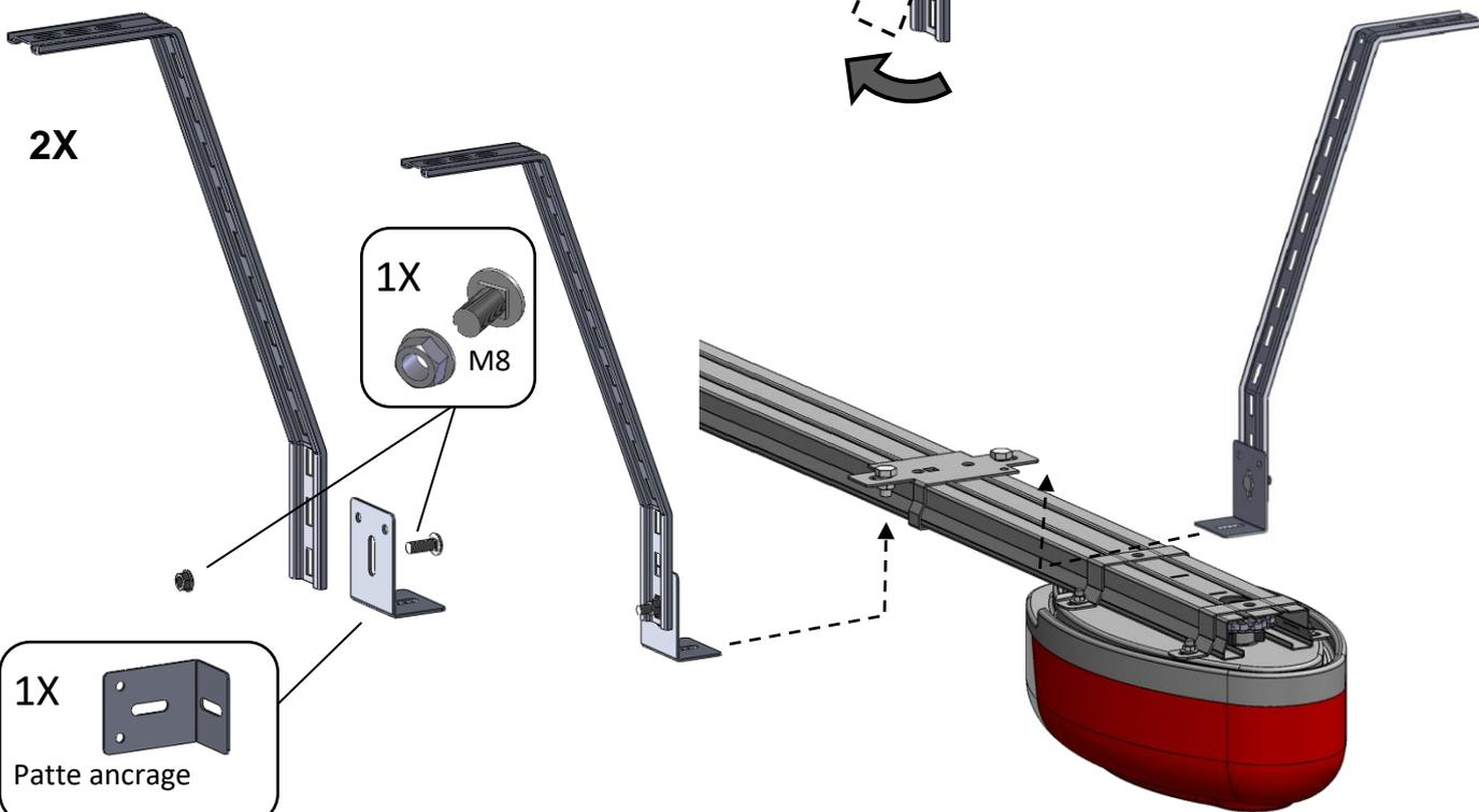
**1- Emboîter les 2 traverses + 2 équerres et clipser les 2 équerres coulissantes**
