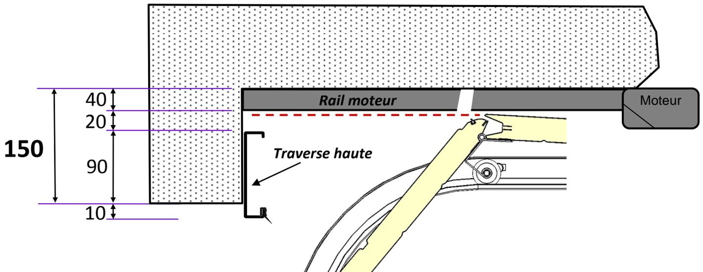
Pour une porte sectionnelle motorisée, nous préconisons une retombée de linteau minimum de 150mm
