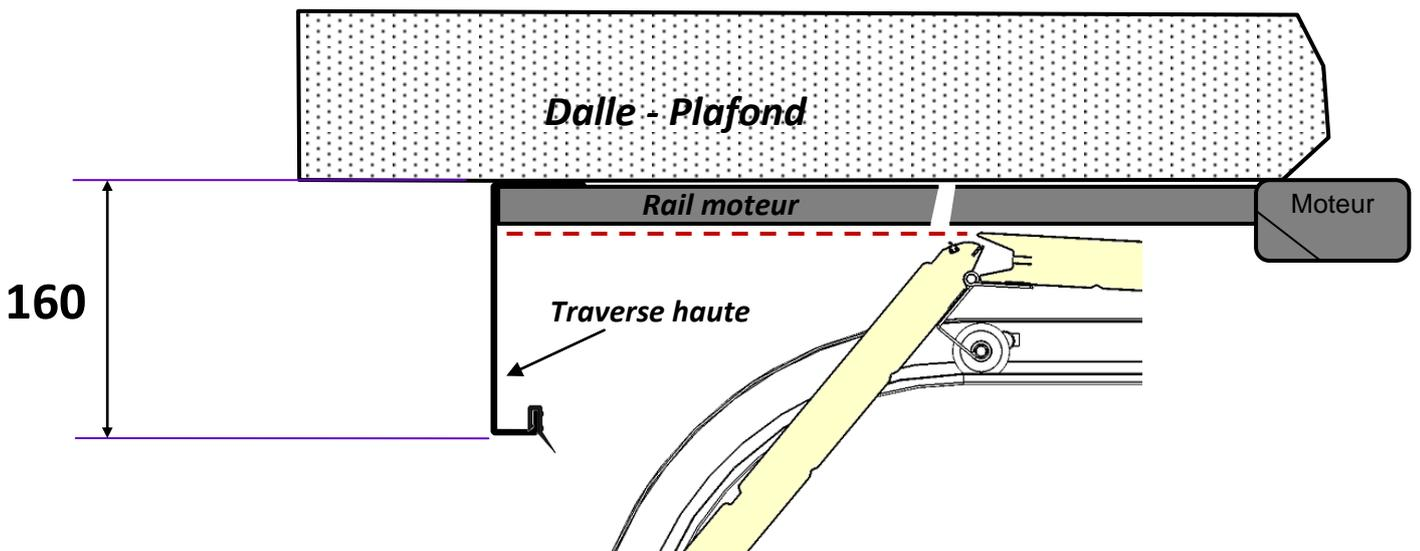
La traverse haute élargie de 160mm « Velette » permet une pose directe sous dalle. (L'encombrement du rail moteur est intégré)
