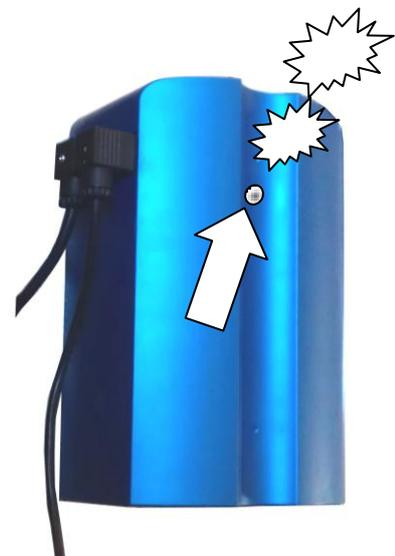
**Un témoin lumineux sur la batterie doit se mettre à clignoter (+ ou- rapidement selon l'exposition au soleil)**
