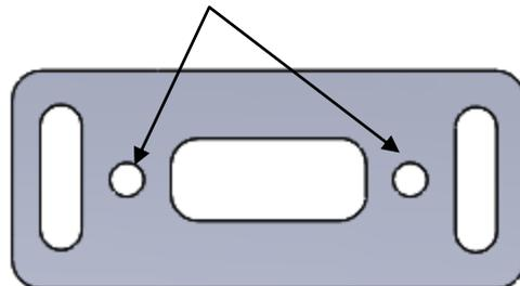
3) Ajuster la course du pêne au niveau de sa fixation sur la sortie du coffre
