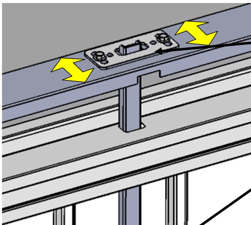
1) Ajuster la position de la gâche sur la traverse haute pour assurer une bonne fermeture de la porte
