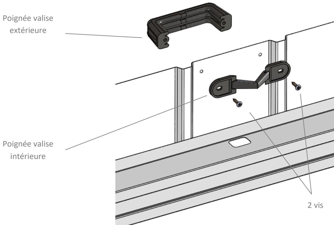
La porte se manœuvre avec les 2 mains. Pour ouvrir appuyer sur la poignée haute et tirer sur la poignée basse. Inversement pour la fermeture
