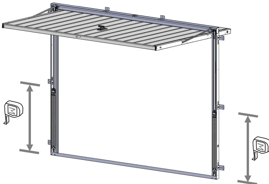
7) Desserrer légèrement le nœud coulant pour remonter / descendre la hauteur des poulies (= de chaque côté)
