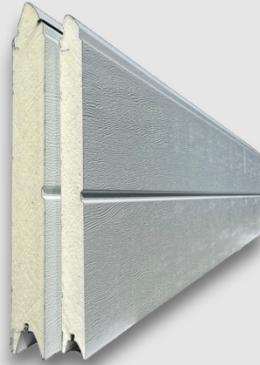
Avec un U de 0.34, les panneaux ISO60 offrent une résistance thermique 47% supérieure à celle des panneaux ISO40 (U = 0.50 W/m<sup>2</sup>K)
